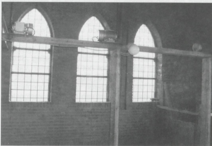
De klokken van de Donatuskerk worden, zoals reeds vermeld, aangedreven door middel van elektromotoren die handmatig worden ingeschakeld.
